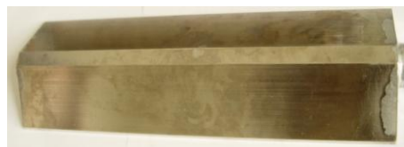
图 1 铝合金与不锈钢环路热管焊接样件
