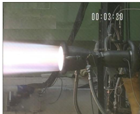
图 3 甲烷液氧气液喷注器热试照片
