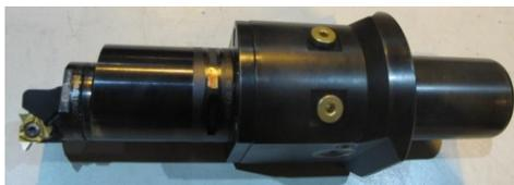
图2 新型涂层硬质合金刀具及刀杆
