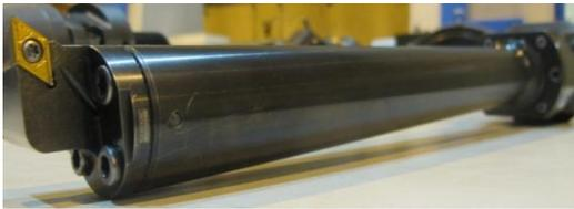
图 12 镗孔刀杆图示
