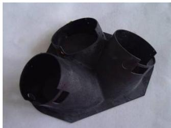
图5 缝合-RTM 工艺接头
