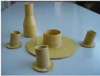
图4 三维机织-RTM 工艺接头
