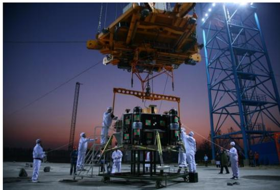
图1 “嫦娥”着陆器悬停、避障、缓降试验
