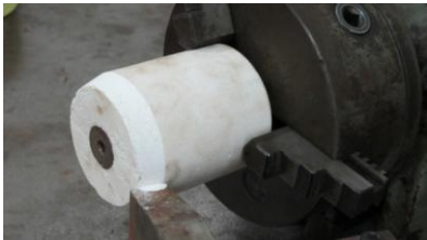
图 6 水溶性芯模的加工性能
