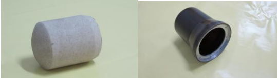
图 9 罩形结构件水溶性芯模和复合材料产品
