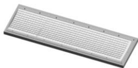
图 2 具有工艺加强框的零件结构示意图
