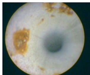
图 7 腐蚀(不锈钢导管)
