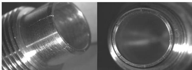
图2 裂纹的宏观形貌(侧面和端面)
