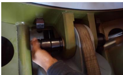
图 6 起竖油缸使用工装轴装配后
