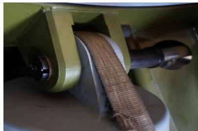
图 5 起竖油缸使用工装轴装配前
