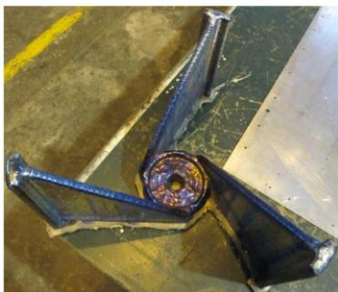
图2 支撑框激光快速成形产品
