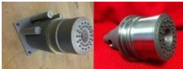
a 3D 打印的喷注器
