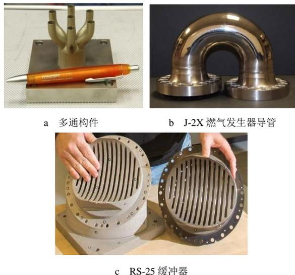
图 6 NASA 采用 SLM 技术成形技术制备发动机零部件
