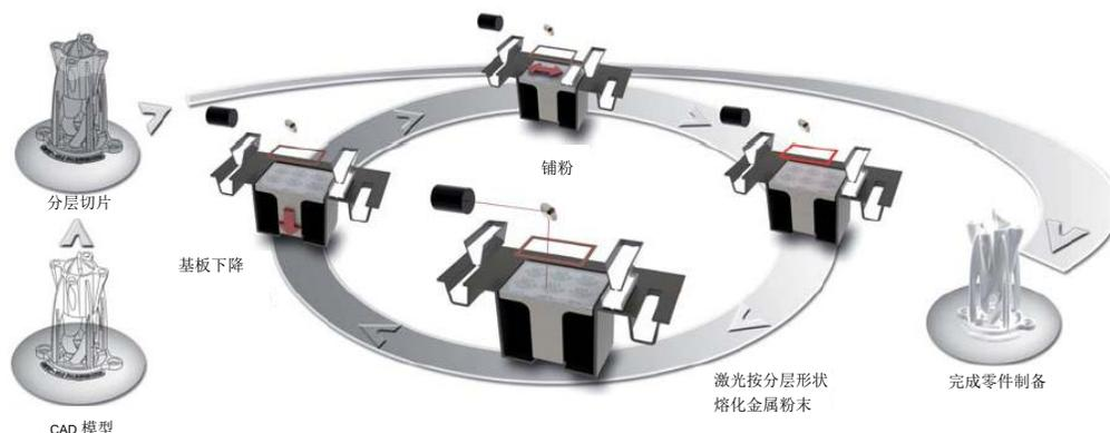
图1 选区激光熔化成形基本流程<sup>[4]</sup>
