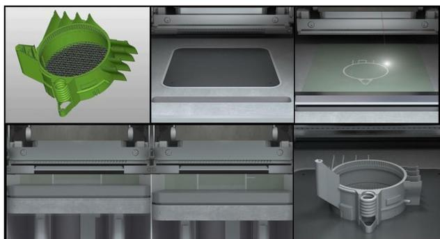
图2 铺粉式激光快速成形流程示意图
