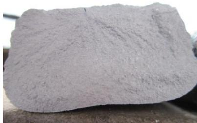
图4 镁合金试样断口形貌
