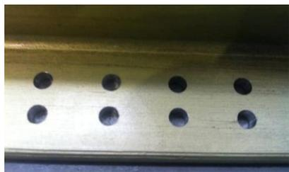
图4 无毛刺钻孔实物
