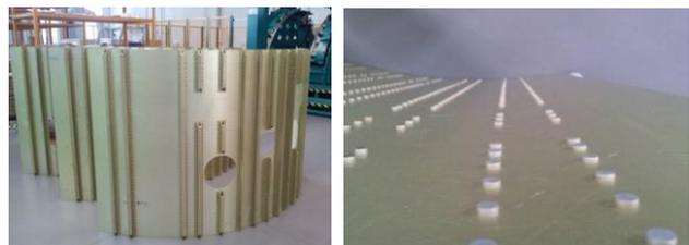
图7 自动化铆接壁板产品
