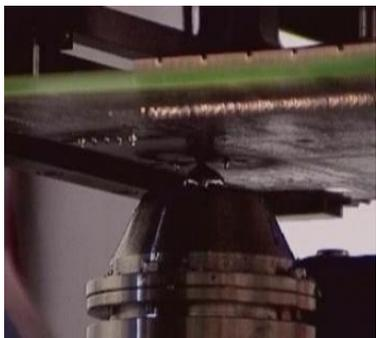
图1 选择性波峰焊逐点焊接示意图
