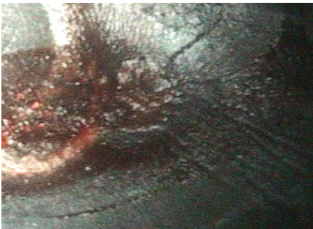
b 裂纹二宏观形貌
