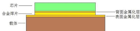
图1 功率芯片共晶结构示意图
