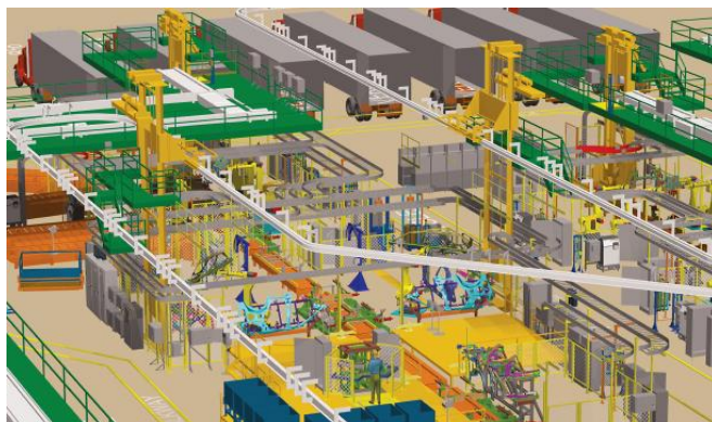
图 1 使用 Tecnomatix 进行机械手装配生产线的仿真优化
