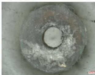
图 4 塑料块撕裂断口宏观形貌
