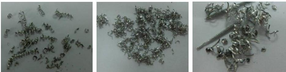
图 8 组合加工过程中车削、铣削、钻孔产生的多余物
