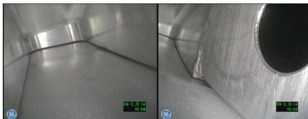
图 11 使用内窥镜（视频镜）进行多余物检查
