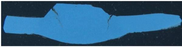
图6 焊缝接头低倍组织
