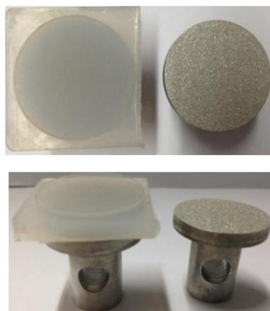
图 4 聚全氟乙丙烯/铝合金菌状物扯离试验后试样 (下转第 31 页)
