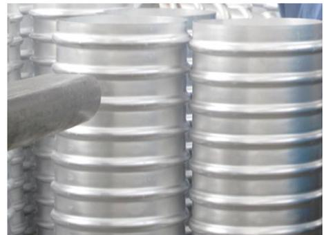
图7 波纹管液压成形件
