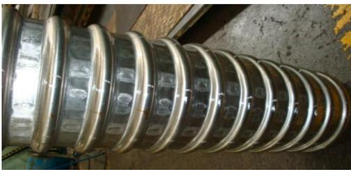
图1 压弯+焊接成形的波纹管
