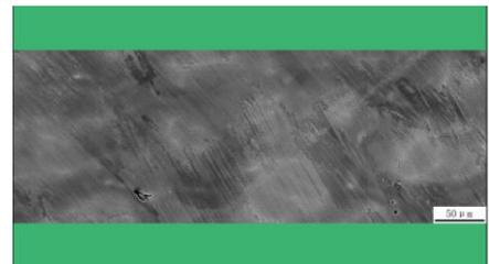
a 层片组织背散射电子像
