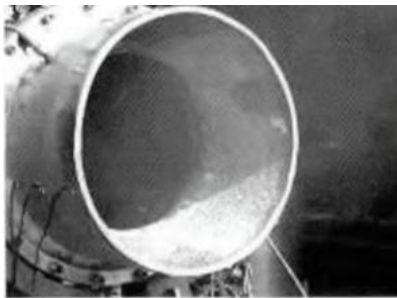
图2 C/C-SiC燃烧室和喷管及热试车
