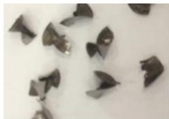
c 转速 $200\sim 500\text{r/min}$ ; 进给 $0\sim 20\text{mm/min}$
