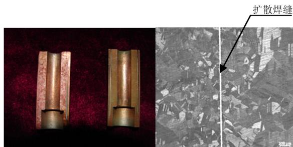
图5 扩散焊铜喷嘴宏观及金相组织照片
