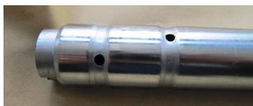
图 4 工艺台阶螺纹孔
