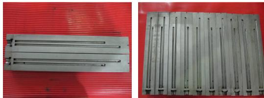
图6 小孔下封闭腔体剖切结果
