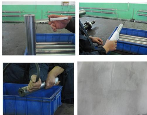
图5 小孔下封闭腔体压缩气体吹除情况
