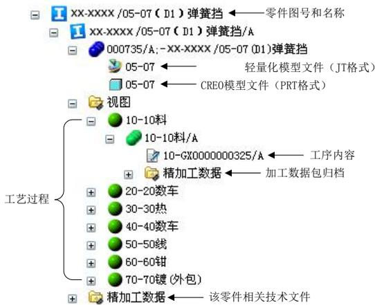
图6 结构化三维模型与工艺
