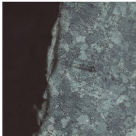
图9 GH720材料重铸层形貌示意图
