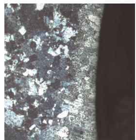
图12 参数匹配后的GH4169材料加工表面形态
