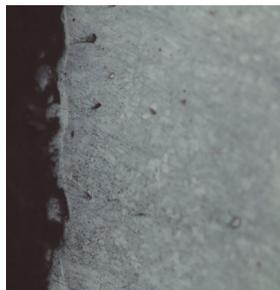
图10 GH4169材料重铸层形貌示意图
