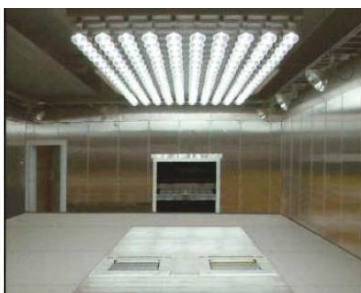
图3 灯阵太阳模拟器
