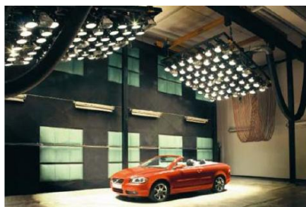
图3 灯阵太阳模拟器
