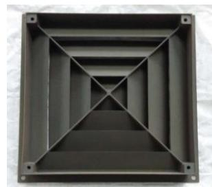
图7 SLM 成形的航天器某通风结构
