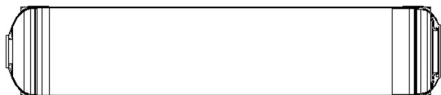
图 1 大型发动机碳纤维缠绕壳体示意图
