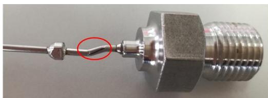
图6 扭转试样失效形貌
