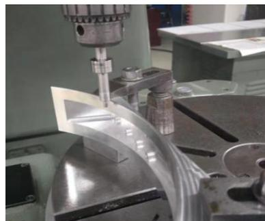
图 4 寻边器获取  $B_1$ 、 $B_2$  位置坐标值
