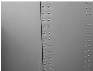
图3 已涂胶的蒙皮与蒙皮搭接缝隙
