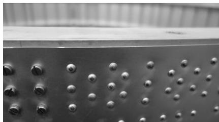
图2 未涂胶的蒙皮与端框搭接缝隙
