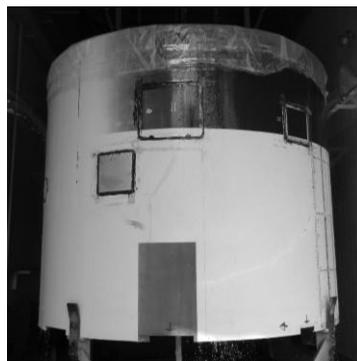
图4 铆接舱体淋雨试验
