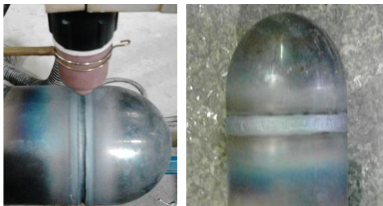
图6 贮气罐产品打底、盖面后焊缝外表面
