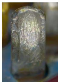
图2 激光两次搪锡后外观图
