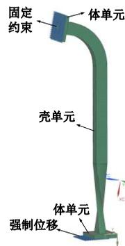
图 7 波导有限元模型
