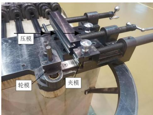
图2 手动弯管机实物图
