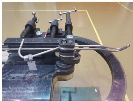
图4 用样件比对产品旋转角度
