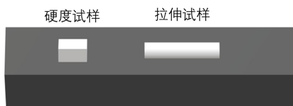
图1 硬度和拉伸试样取样示意图
