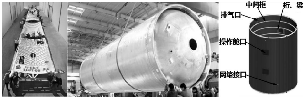
图 1 典型的箭体用弱刚性薄壁结构 [8-9]
