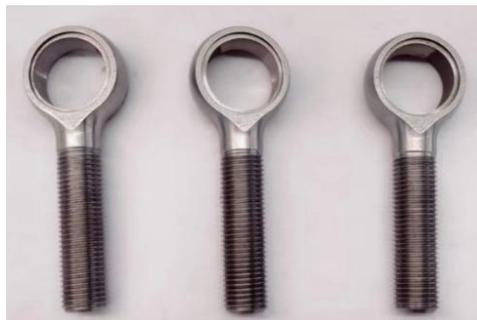
图1 带杆端轴承外圈整体结构示意图
