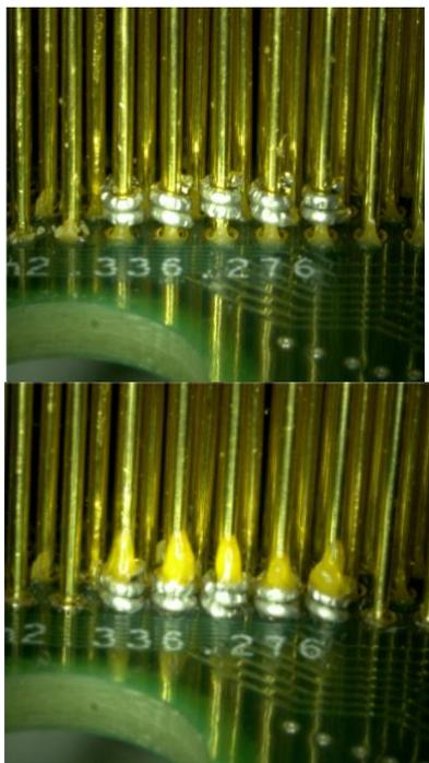
图4 助焊膏点涂方式图
