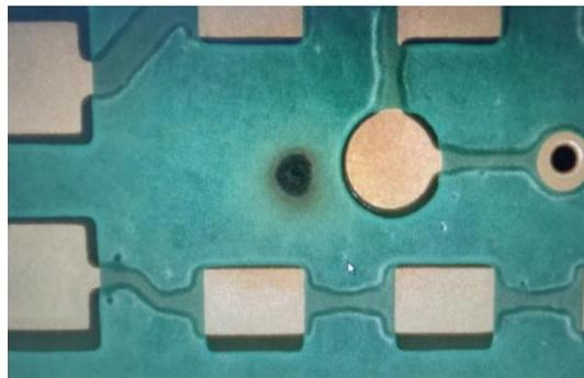
图7 激光烧伤板卡形貌图
