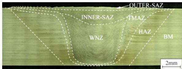
图4 无减薄搅拌摩擦焊横截面宏观金相
