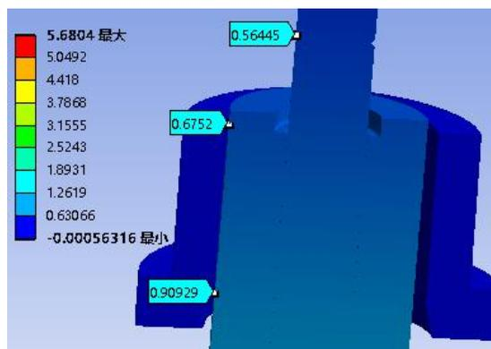
图 6 BI3 CENTRIO70 轴系的应变云图
