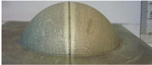
图9 激光焊接 LZ91 镁锂合金超塑胀形半球
