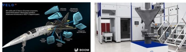
a 超音速飞机 XB-1 b 喷气式飞机前起落架 图 1 3D 打印技术在航空航天领域上的应用
