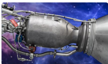
图 7 Orbex 公司 L-PBF 技术打印的一体化推力室
