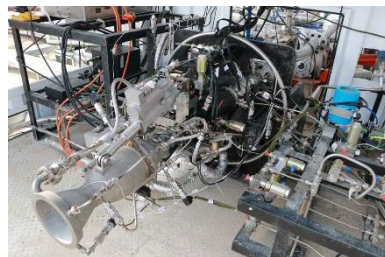
图 12 江苏深蓝航天有限公司推力室试车状态
